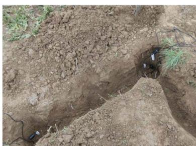
Le site de Bram s'est équipé d'une vingtaine de sondes afin d'étudier l'impact du positionnement du système d'irrigation (aérien / enterré sous le rang / enterré dans l'inter-rang) sur le bulbe d'humidité et les rendements.
